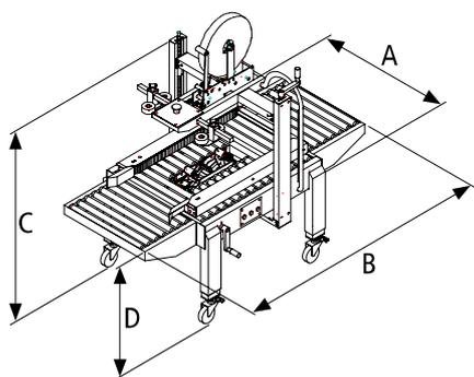
Lepicí automat CT 103 SD uzavírá v jednom pracovním cyklu spodní i horní víko krabice stejných velikostí. K protažení krabice zalepovací hlavou je použit boční pohon. Skládací krabice jsou manuálně vloženy. Přestavení na jinou velikost krabic se provádí jednoduše pomocí zařízení pro rychlé nastavení poháněných bočních pásů a nastavením výšky agregátu.
