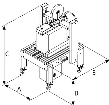
Lepicí automat CT 105 SDR uzavírá v jednom pracovním cyklu spodní i horní víko krabice různých velikostí. K protažení krabice zalepovací hlavou je použit boční pohon. Skládací krabice jsou manuálně vloženy. Automatické přizpůsobení se krabicí regulováno nastavitelným tlakem pomocí pneumatického válce.
